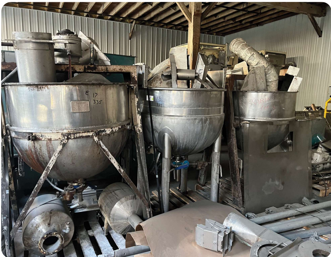
Tanques de vapor (sistema de cozimento)
